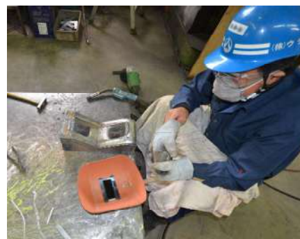
破碎機の刃の再生もりつけ
