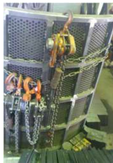
破碎機の部品 (オーバーサイズをリターンさせるために使用)
