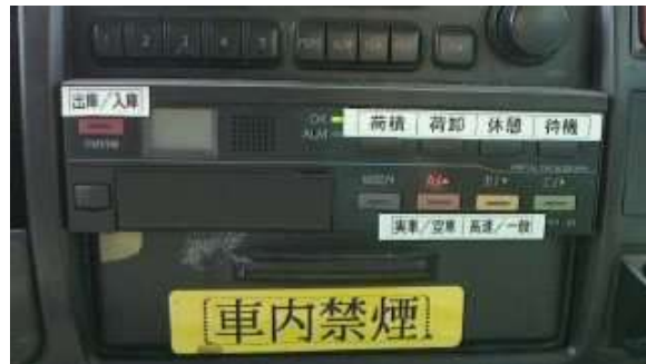
デジタルタコグラフを搭載した車両内部
