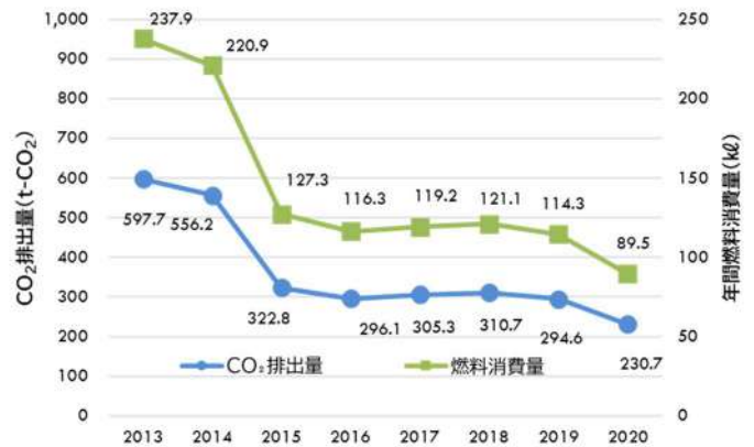
使用重機によるCO 2 排出量
