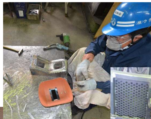
破碎機の刃の再生もりつけ
