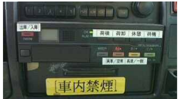
デジタルタコグラフを搭載した車両内部
